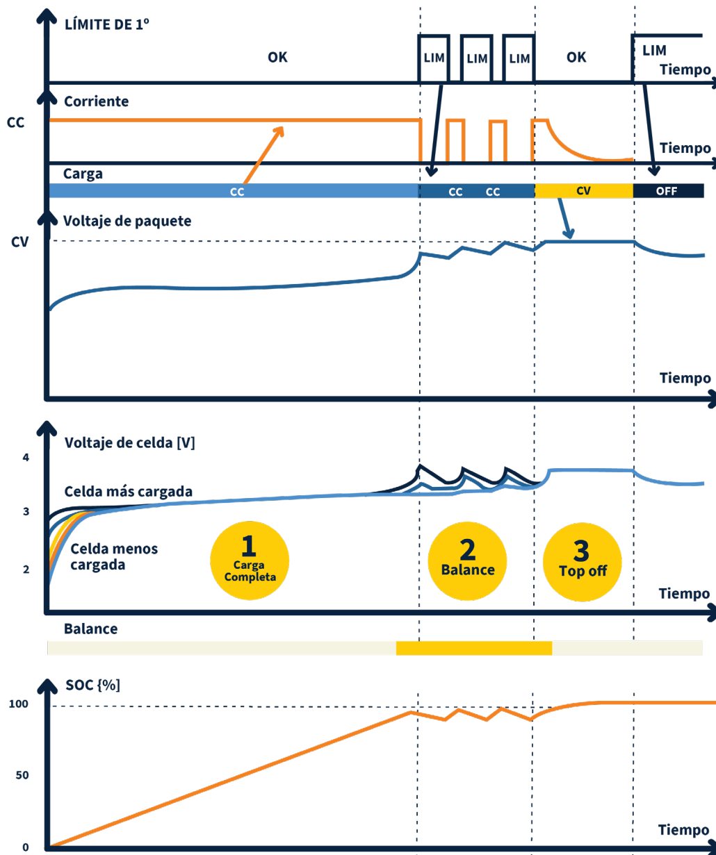
FIGURA 8: Ejemplo de proceso de carga por CCCV con balanceo de baterías [22].
