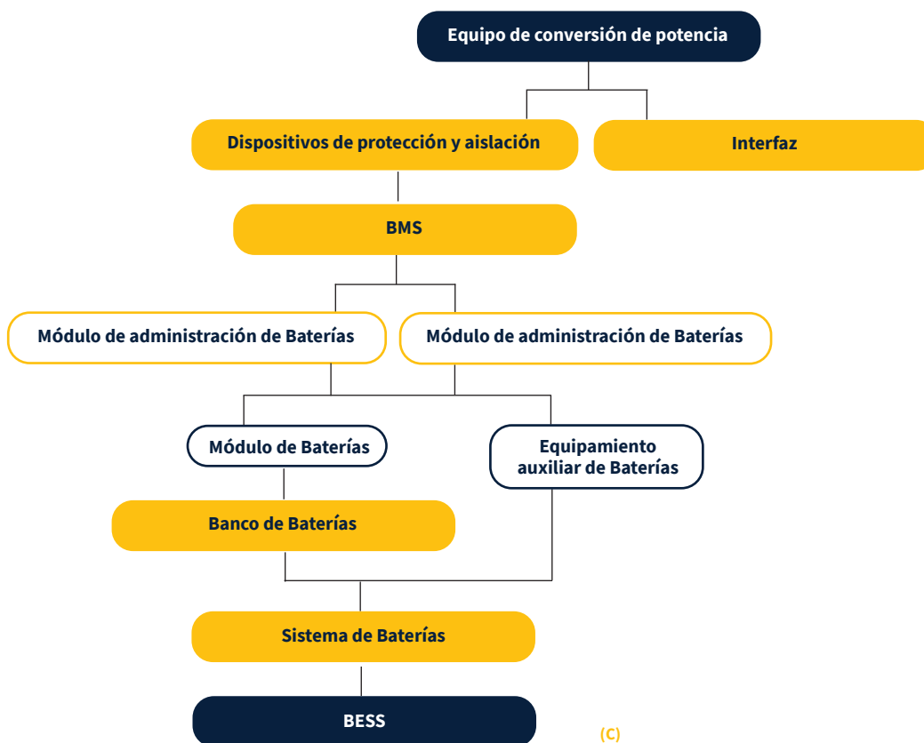
FIGURA 9: Ejemplos de estructuras de BESS según su química (según norma AS/NZS 5139). (A) Ion litio; (B) Níquel-cadmio o plomo ácido; (C) batería de flujo.
